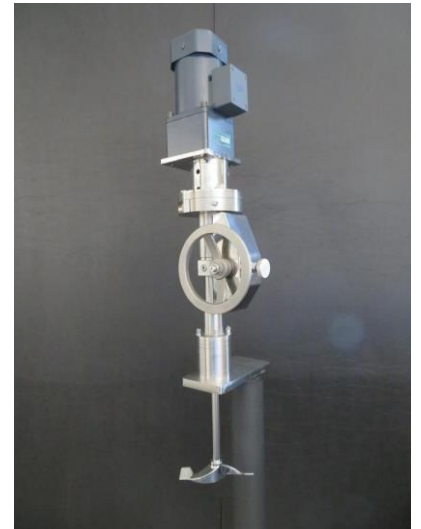
写真3 昇降式攪拌装置の取り付け (多機能型ろ過乾燥機として兼用)
