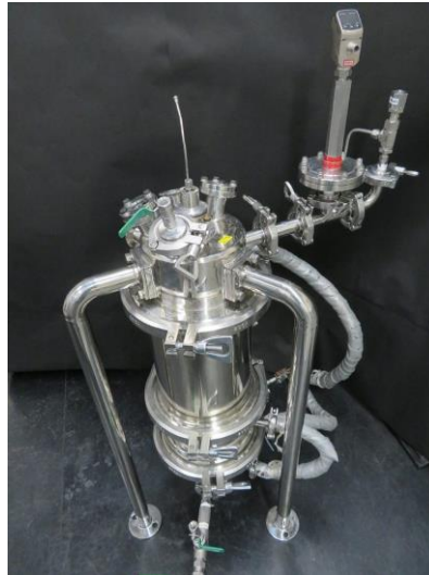
写真2 微粒子回収槽の外観
